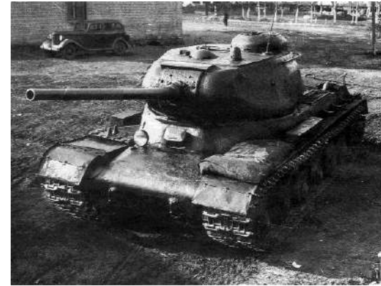
Название: ИС-1 . Советский тяжёлый танк периода Второй мировой войны. Аббревиатура ИС означает «Иосиф Сталин» — официальное название серийных советских тяжёлых танков выпуска 1943—1953 гг. Индекс 1 соответствует первой серийной модели танка этого семейства. В годы Второй мировой войны вместе с обозначением ИС-1 на равных использовалось название ИС-85 , в этом случае индекс 85 означает калибр основного вооружения машины. Создатели: Ж.Я. Котин , А.И. Благонравов , Н.Л. Духов
