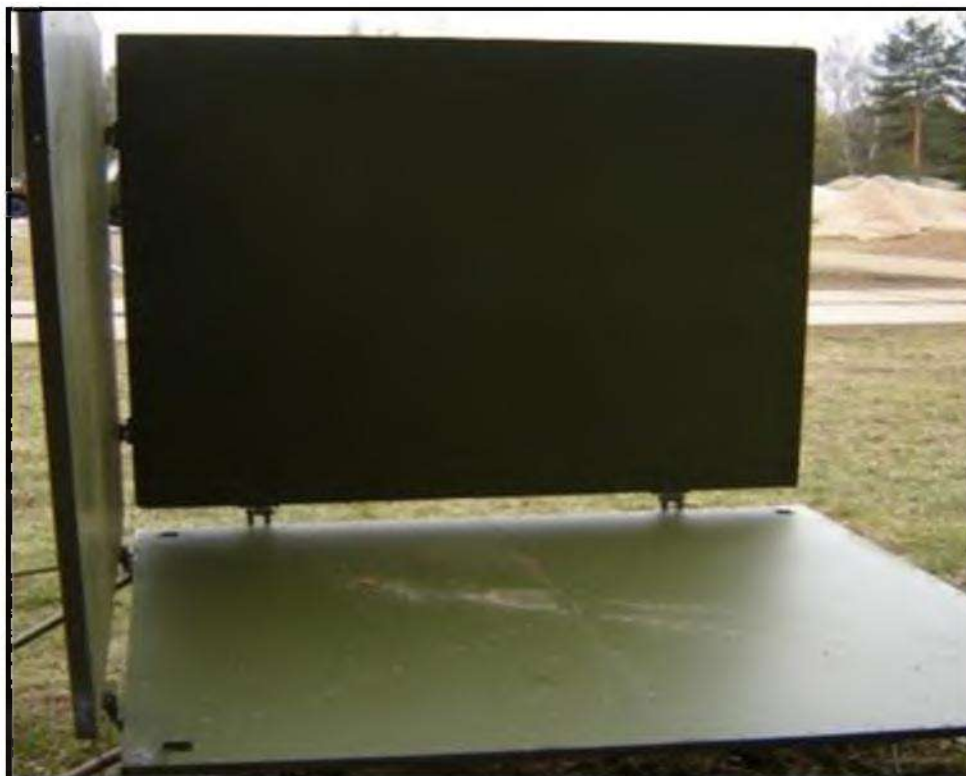
Рисунок III.45 – Пример размещения радиолокационных уголковых отражателей «Угол»
