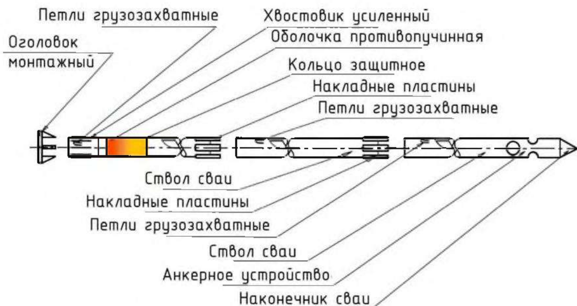
Рисунок III.41 – Свая «СМОТ». Основные элементы
