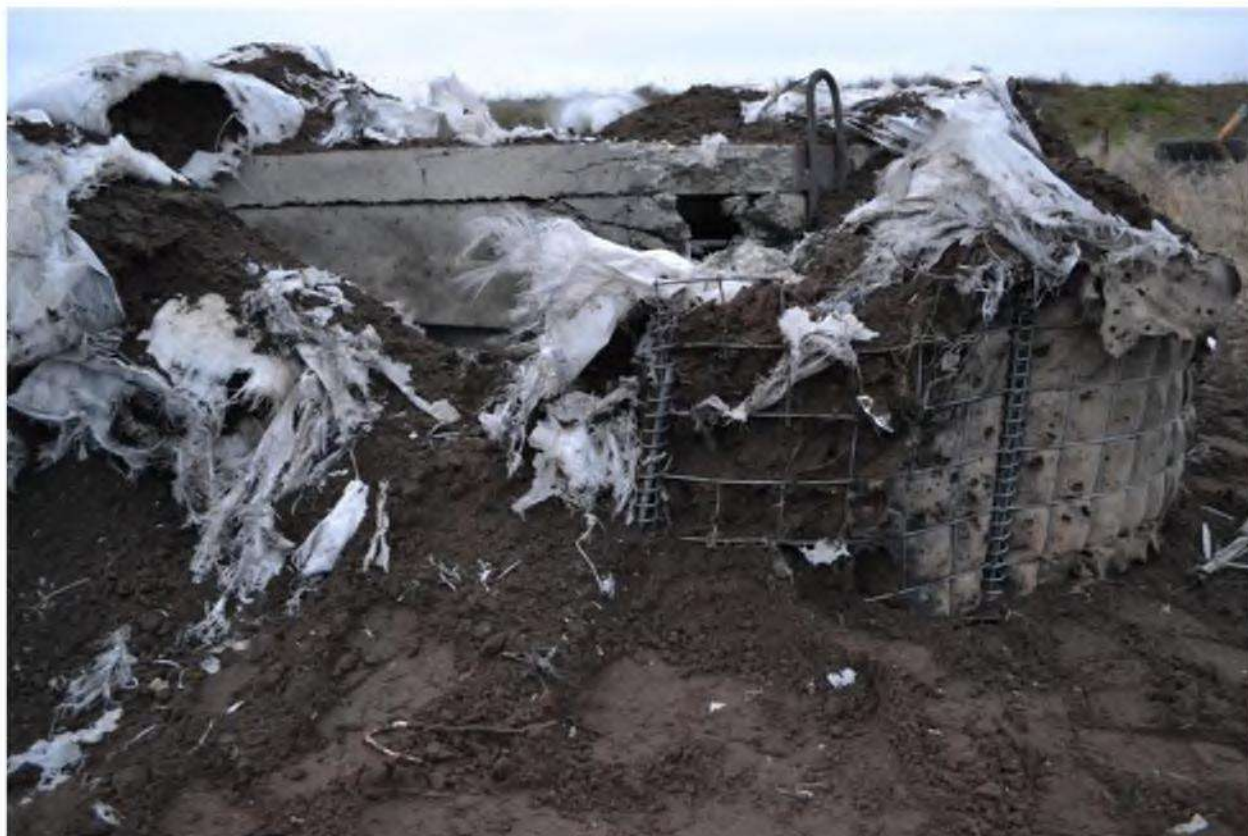
Рисунок I.1 – Войсковое фортификационное сооружение для ведения огня, изготовленное на гражданском заводе железобетонных конструкций после испытаний
