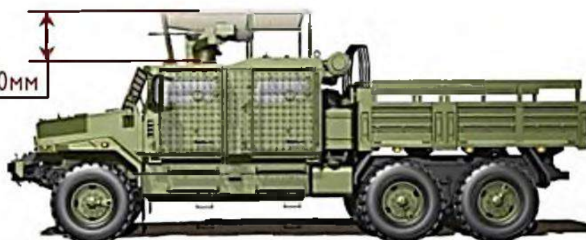
Рисунок III.15 – Рекомендации по установки защитных сеток и козырьков
