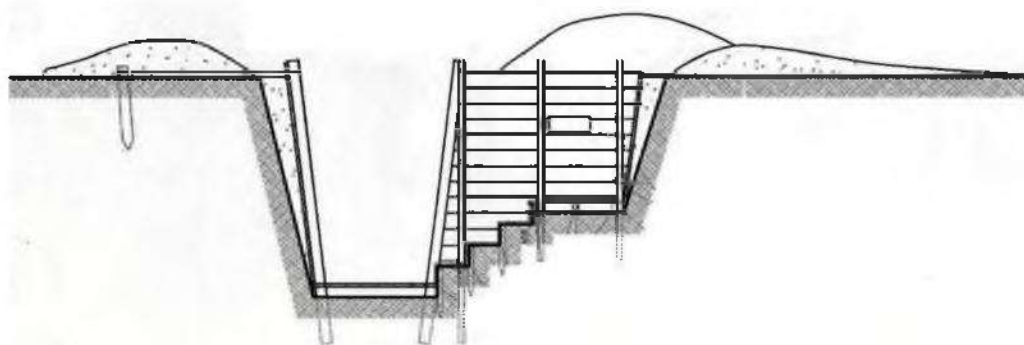
Рисунок III.1 – Разрез примкнутой стрелковой ячейки без защиты от БПЛА. Вариант
