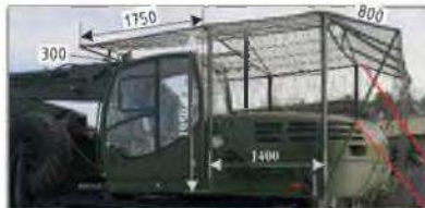
Защита оборудования (вид слева)
