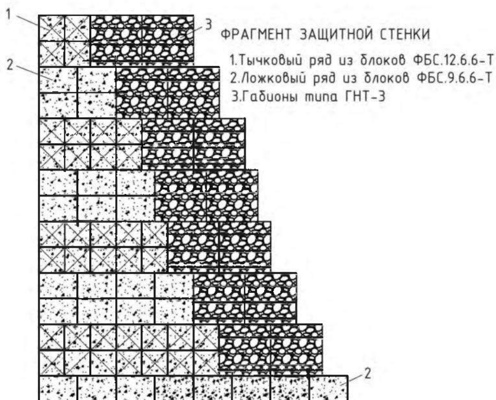
Рисунок IV.7 - Фрагмент защитной стенки
