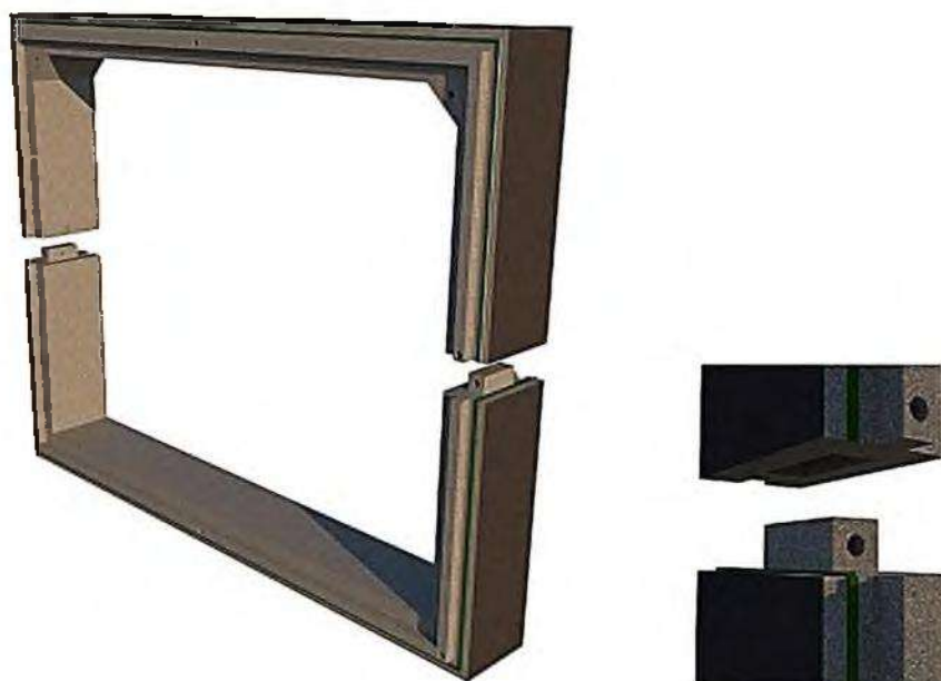
Рисунок V.22 - Вариант членения рамы без учёта эпюры моментов
