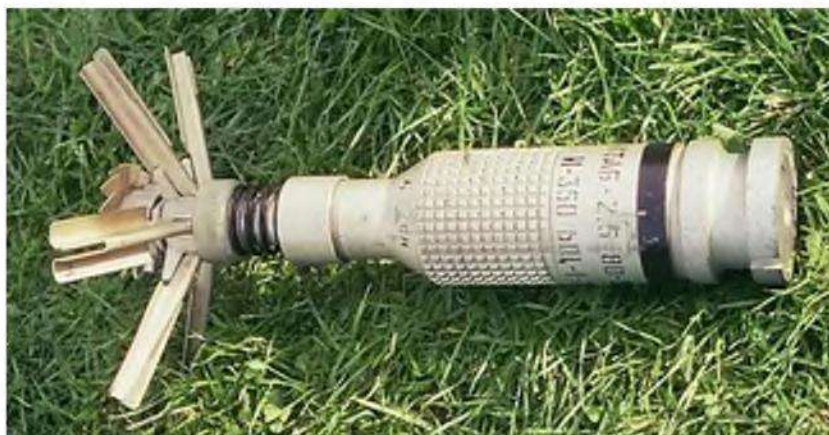
Рисунок I.10 - Кумулятивно-противотанковая авиабомба ПТАБ-2,5КО
