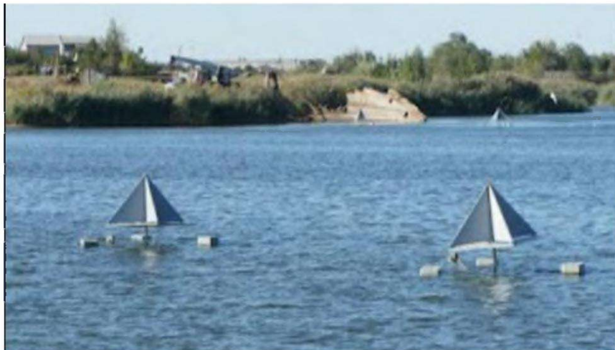
Рисунок III.49 – Пример размещения отражателей «Пирамида» на водной поверхности
